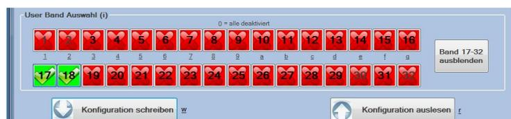
Je nach Anwendungsfall wird unter Umständen mehr als eine User Band-ID pro Antennensteckdose freigegeben. Zum Beispiel werden für Twin-Receiver zwei User Band-IDs benötigt.
